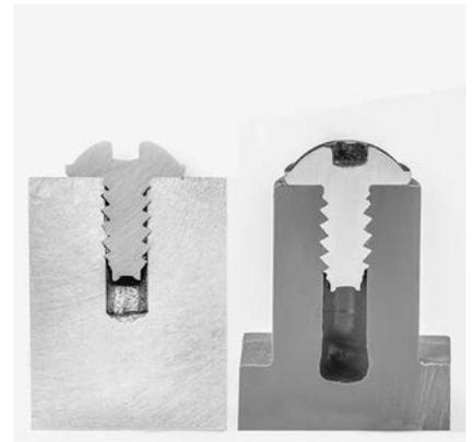
Possibilità di ottenere un'elevata copertura del profilo del filetto in caso di avvitiamenti in leghe leggere e materie plastiche
